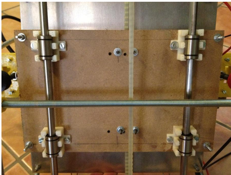
Figura 151. Mejora. Rodamientos lineales, modelo LM8UU, del eje Y
