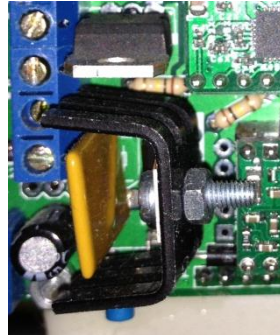
Figura 137. Disipador del mosfet conectado a la clema de alimentación para la heated bed
