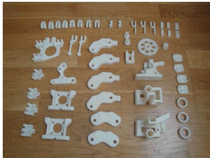
Figura 11. Primer juego de piezas para clonar una Prusa Mendel Iteración 2 hecho por un clon del Proyecto Clone Wars, por la Prusa Mendel, R2, de Juan González Gómez.
