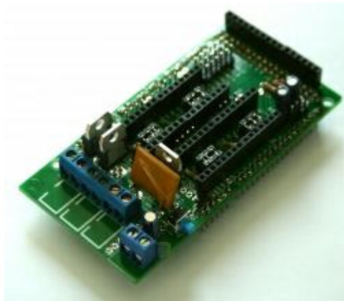
Figura 118. Ramps 1.2 completamente ensamblada
