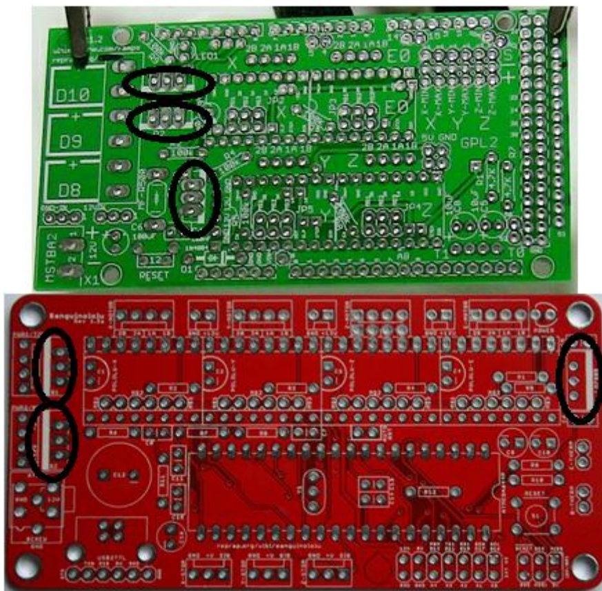
Figura 136. Marca que indica la posición del mosfet en la placa, en una Ramps 1.2 (arriba) y una Sanguinololu 1.3a (abajo)
