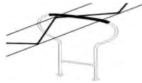
fig. 9.12. Zig-zag contact wire
