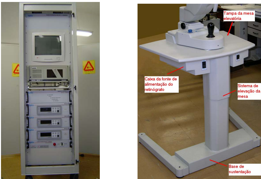
Figura 60 - Ilustrativo de equipamentos de suporte para produtos mecatrônicos: (a) rack de unidade de medição de circunferência; (b) mesa elevatória de retinógrafo digital.
