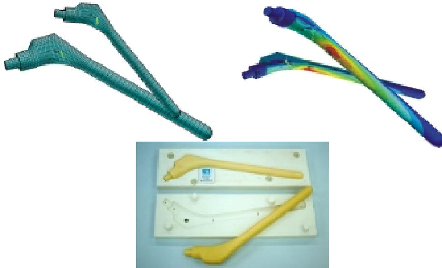
Figura 6.7: Protótipos e ferramental rápido (exemplo de próteses biológicas)
