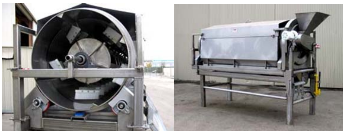
Figura 10 - Processo Combinado por Escovação com Jatos de Água em Tambor Rotativo (VWM WORKS, 2005)
