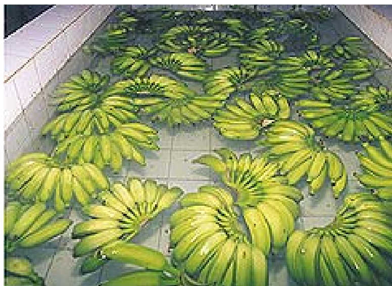
Figura 11 – Sistema de limpeza de Bananas por Imersão.
