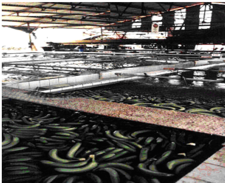
Figura 12 – Sistema de Limpeza de Bananas por Processo Combinado (EMBRAPA, 2004).
