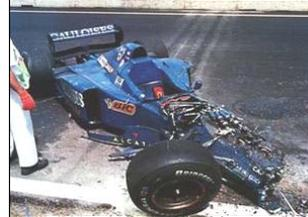
O primeiro chassis totalmente em compósito apareceu em 1981 (McLaren MP4-1). O chassis da figura à direita é o Prost AP-01 em fibra de carbono/epoxy, depois de um acidente (Canadá 1997). O habitáculo é sujeito, por regulamento, a testes de impacto, tendo sofrido dois embates laterais nos muros de betão do Circuito, o primeiro dos quais a cerca de 180km/h. Num chassis em alumínio, o piloto teria certamente perdido a vida. Os compósitos vulgarizaram-se na F1 a partir de 1983.
