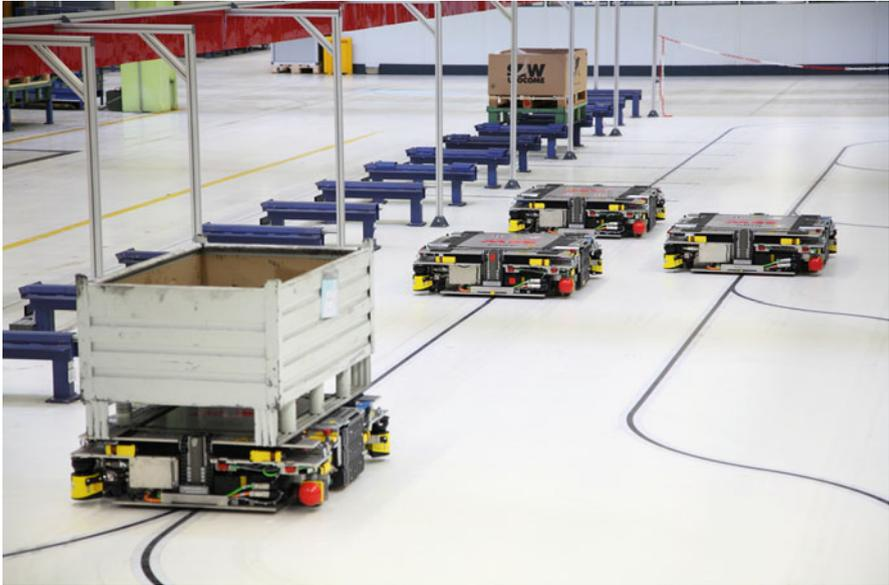
**Abb. 7** Materialbereitstellung mit autonom agierenden Logistikassistenten
