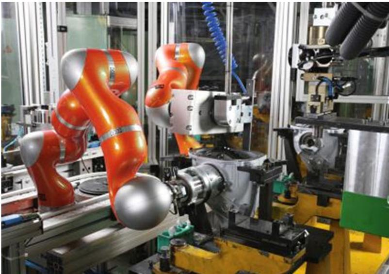
**Abb. 9** Hinterachsgetriebemontage mit sensitivem LBR iiwa
