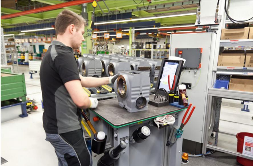
**Abb. 9** Montageassistent als mobile Werkbank in der Getriebemontage
