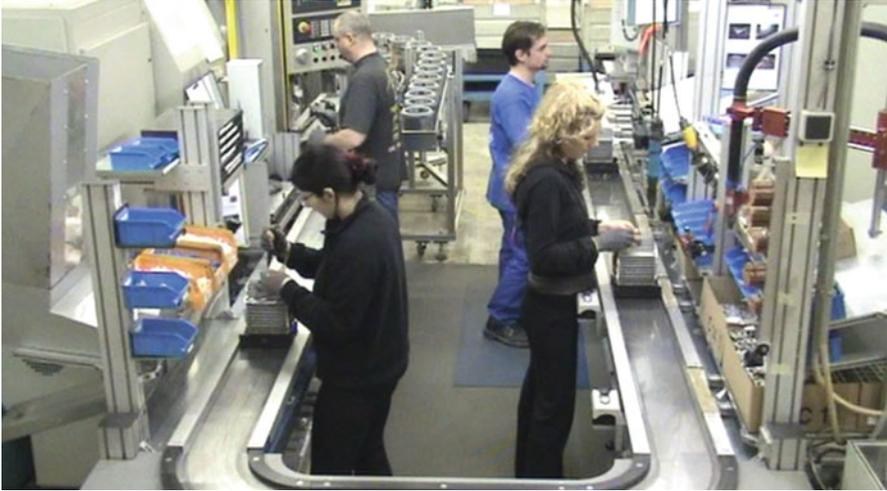
**Abb. 4** Flussorientierte Arbeitsinsel in der Motorenfertigung in Haguenau/Frankreich
