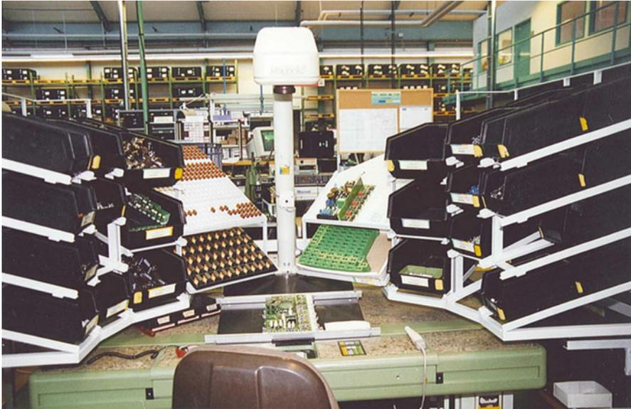
**Abb. 3** Bestücktisch in der Elektronikfertigung Bruchsal nach dem Best-Point-Prinzip
