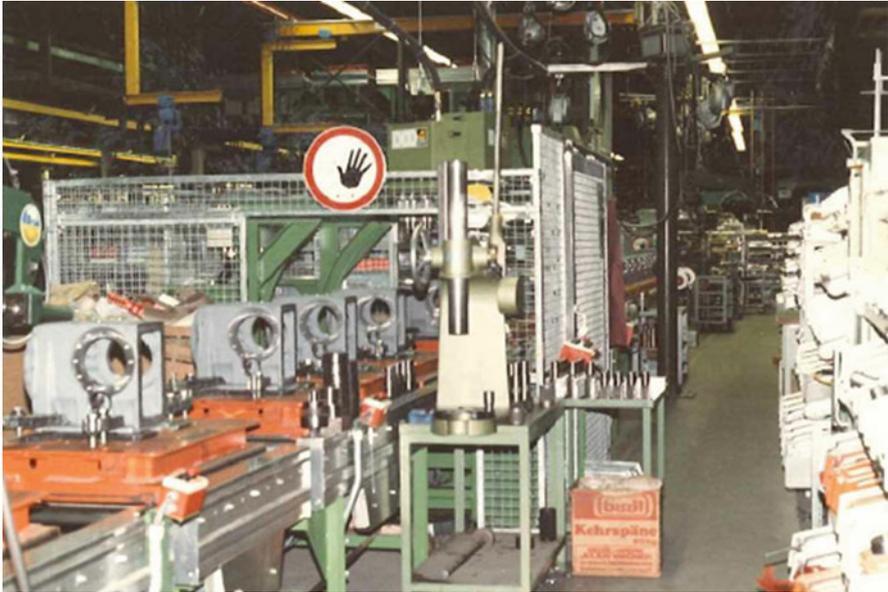
**Abb. 1** SEW-Getriebemontagelinie nach dem CIM-Konzept im Jahre 1985
