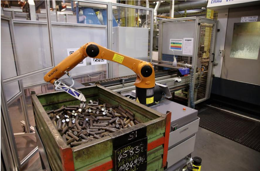
**Abb. 10** Mobiler Handlingsassistent in der zerspanenden Fertigung
