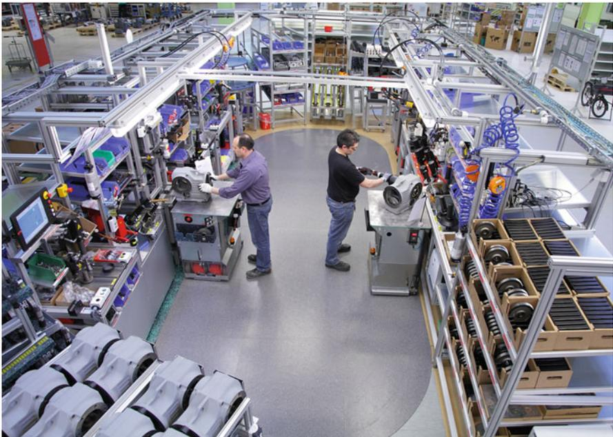
**Abb. 8** Optimierte Montageinsel in der Getriebemontage in Graben-Neudorf nach den Gestaltungsprinzipien Lean und Industrie 4.0
