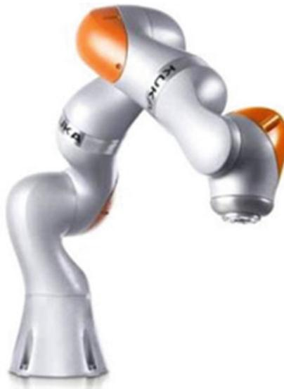
**Abb. 8** Sensitiver Leichtbauroboter Kuka LBR iiwa
