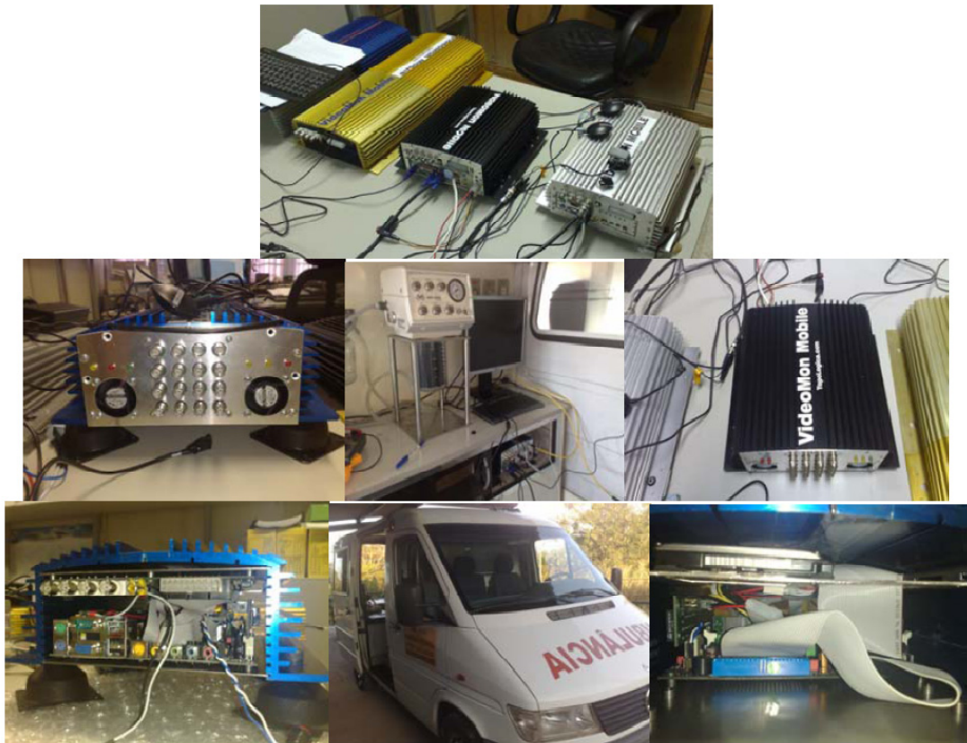
Figura 2.1 – Gabinete VideoMon Mobile e aplicação em ambulância.
