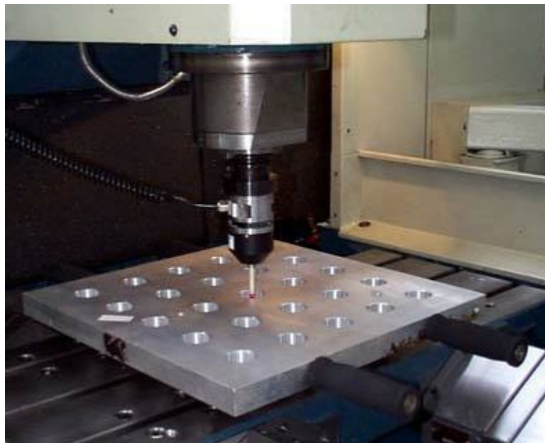
Figura 6.13 – Ensaio geométrico com a placa de furos no plano XY
