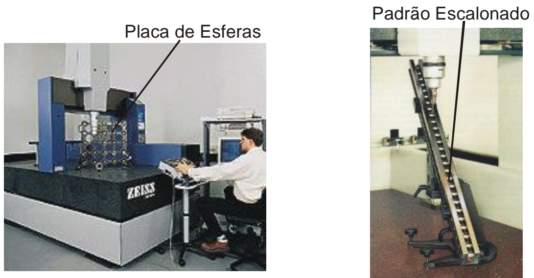
Figura 4.2 - Qualificação de Máquinas de Medir por Coordenadas com padrões corporificados
