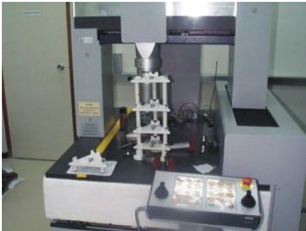
Figura 4.15 - Calibração do padrão vertical na Máquina de Medir por Coordenadas
