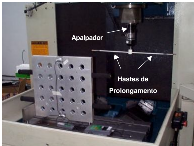
Figura 4.10 – Adaptação do apalpador para medir a placa de furos na vertical
