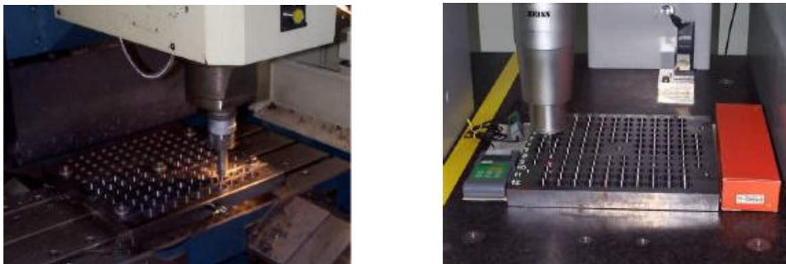
Figura 6.36 - Usinagem e Medição de uma placa de furos para a verificação da eficiência da correção eletrônica da máquina-ferramenta
