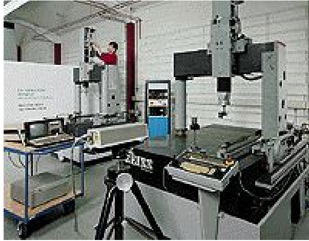
Figura 4.1 - Calibração de Máquina de Medir por Coordenadas com laser interferométrico
