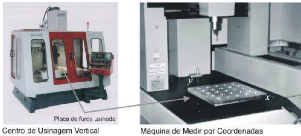
Figura 3.10 - Usinagem e verificação da exatidão de trabalho de uma Máquina-ferramenta
