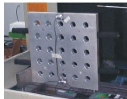
Figura 4.11 - Protótipo desenvolvido: Placa de Furos como padrão corporificado bi-dimensional
