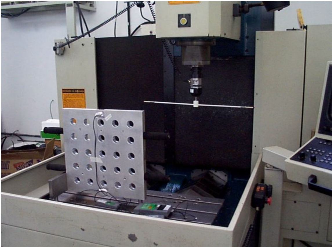
Figura 6.20 – Ensaio geométrico com a placa de furos no plano XZ
