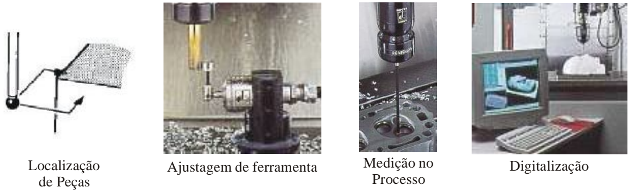
Figura 4.3 - Funções do apalpador na máquina-ferramenta
