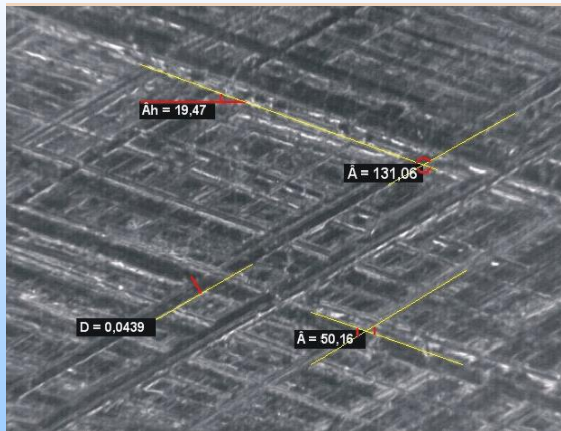
Ranuras em cilindro de motor brunido
