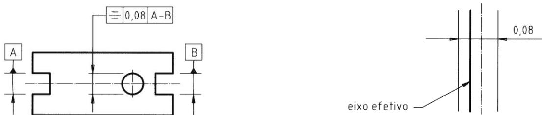
No exemplo anterior, a tolerância de simetria foi indicada em apenas uma direção, sendo que ela pode também ser indicada em duas direções perpendiculares entre si, como no desenho a seguir.
