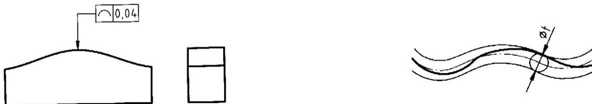
Neste exemplo, o quadro de tolerância mostra que, em cada seção paralela ao plano de projeção, o perfil efetivo deve estar contido entre duas linhas que tangenciam círculos de 0,04mm de diâmetro, que têm seus centros sobre a linha com perfil geométrico ideal.
