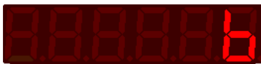
Figura 4.7: Tela da HMI quando selecionado a opção para fazer backup dos parâmetros do controle para o cartão de memória flash ou vice-versa
