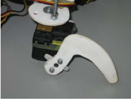
Fig. 5. Vista sobre la disposición de los servos en las patas del mini-robot.
