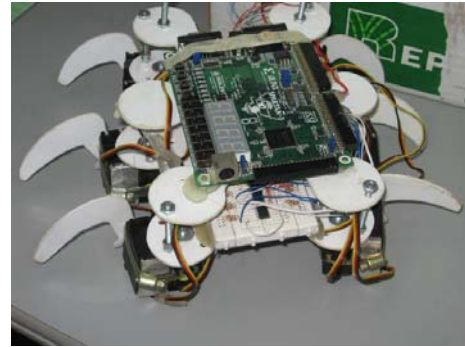
Fig. 3. Vista sobre los avances alcanzados en la construcción del hexápodo
